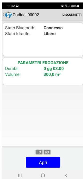
Nella sezione più in alto vengono mostrati, in nero, lo stato della connessione Bluetooth e lo stato in cui si trova l'idrante.
